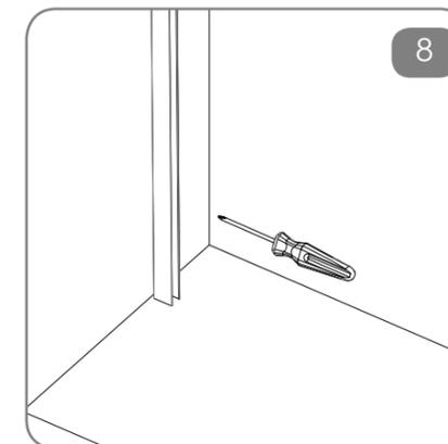
Fissare con delle viti adeguate le guide.
