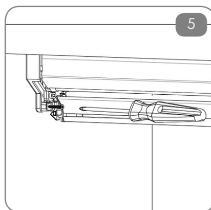
IMPORTANTE: Valutare subito se la tenuta del sistema ad espansione è sufficiente, in caso contrario è necessario fissare le cuffie con viti adeguate allo sfondo.
