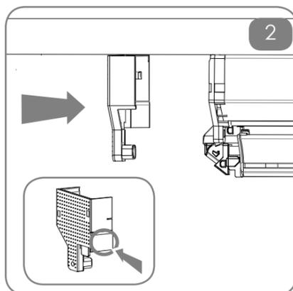
Posizionare le due cuffie alle estremità del cassonetto. Nel caso in cui si utilizzi il doppio comando è necessario rimuovere, con un cutter la plastica segnalata con due tacche.
