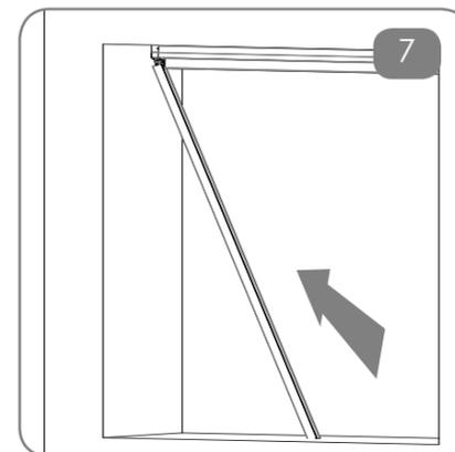
Infilare le due guide laterali (la parte esterna delle guide telescopiche) dentro le alette delle due testate ai lati del cassonetto.
