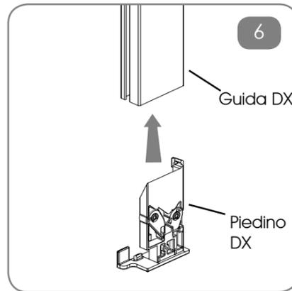
SOLO VERSIONE MOLLACATENA: Inserire nella parte interna delle guide telescopiche i piedini (in basso) e gli imbocchi (in alto).
