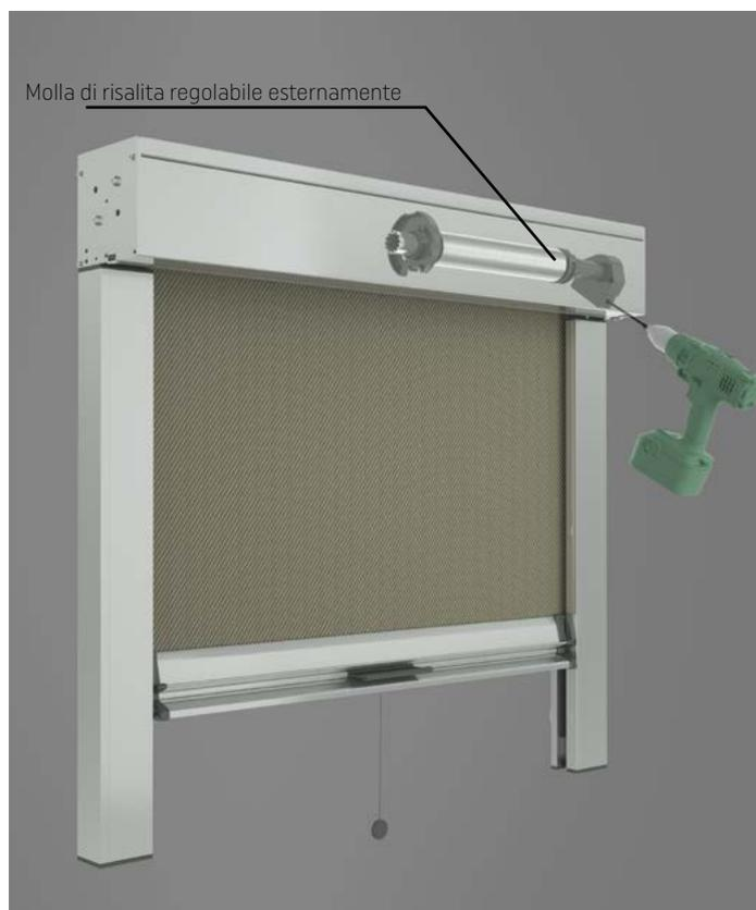
La regolazione della forza di risalita si effettua tramite un comune avvitatore a tenda montata agendo su un piccolo argano interno.
