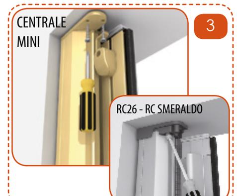
Versione centrale mini: Fissare al soffitto la testata superiore
