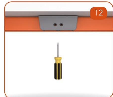
Fissare con una vite il fermo superiore.
