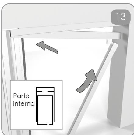
Posizionare il profilo interno della guida telescopica di seguito il profilo a "U"
