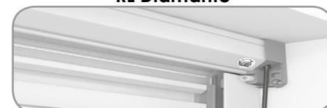
Regolare la carica della molla inserendo l'accessorio esagono in un avvitatore elettrico ed agire nel foro posto nella testata riportante l'adesivo con la "chiocciola".
