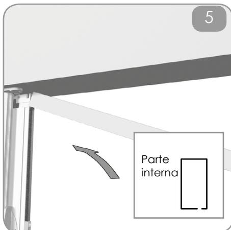
Posizionare la guida superiore infilandola da sotto nell'aletta della testata.
