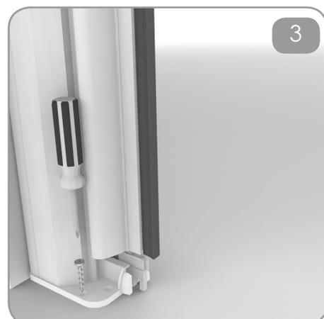
Fissare a terra la testata inferiore del cassonetto.
