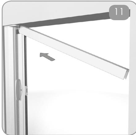
RL MAGNUM/RL DIAMANTE: Posizionare il profilo esterno della guida telescopica nell'aletta e fissarlo.
