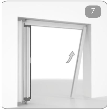
Infilare da sotto la guida di riscontro e fissarla con delle viti.
