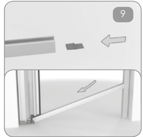
Inserire la piastrina a una estremità della guida inferiore e posizionare la guida a terra.
