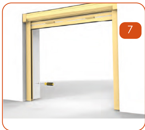
Fissare le guide verticali alle pareti con le viti nella parte inferiore.
