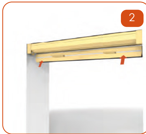
Posizionare il cassonetto al soffitto comprimendo le due mascherine.
