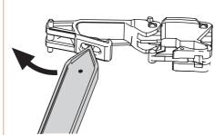
Posizionare la guida di riscontro laterale con le clip dal lato cassonetto. Segnare i fori e fissare con viti e tasselli. Controllare che la distanza fra il bordo inferiore e l'ultima clip non sia inferiore a 30cm
