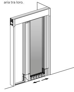
Se necessario, regolare la carica della molla della rete, inserire l'apposita chiave nella vite di regolazione nella parte alta del cassonetto come indicato in figura. Ruotare in senso antiorario per caricare la molla oppure in senso
