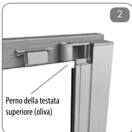
Posizionare il cassonetto in modo tale che la testata con il perno in vista (oliva) sia posizionata dal lato superiore.
