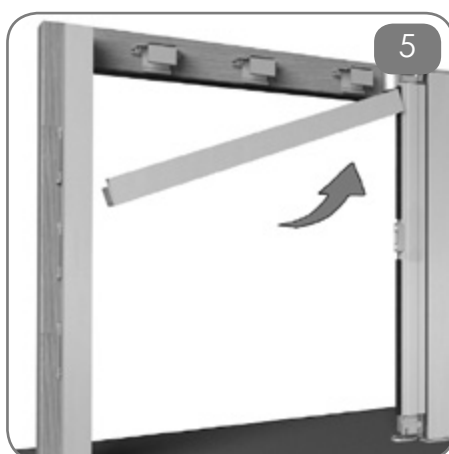
Posizionare la guida superiore in aderenza alle molle e spingere verso l'interno in modo da farla scattare in posizione.
