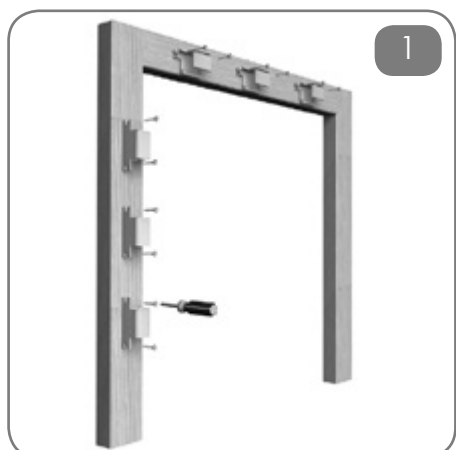
Fissare le molle reggiguida per il successivo posizionamento della guida superiore e della guida di riscontro.
