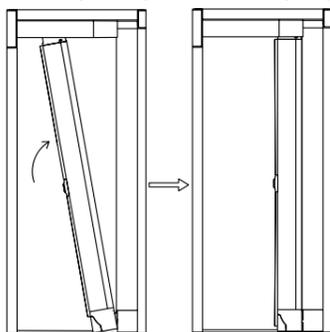
**13** Avvicinare la barramaniglia al riscontro. Ruotare quindi nuovamente dal basso l'inserto telescopico per regolare l'altezza della barramaniglia. Procedere con la regolazione fino a che non sono presenti circa 2 mm di aria fra testata inferiore barramaniglia e pavimento.
