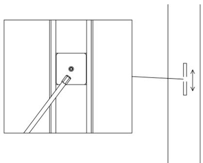
**15** Se necessario, per regolare la carica della molla, sganciare il cassonetto dal riscontro fino a rendere accessibile la vite di regolazione sulla testata superiore.
