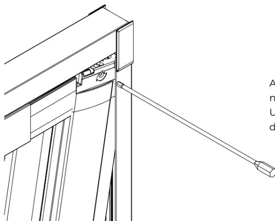
**ATTENZIONE:** allontanare il cassonetto dal riscontro solo lo stretto necessario a rendere visibile la vite di regolazione. Un allontanamento ulteriore potrebbe comportare la rottura della cuffia della guida telescopica
