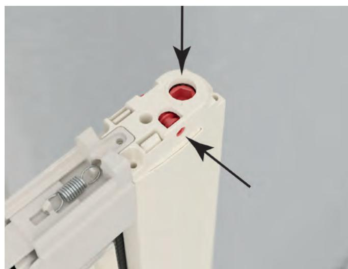
Con Nano Sintesi è possibile registrare velocemente il carico molla sia in fase di premontaggio, tramite un perno superiore diretto perpendicolarmente sulla molla, oppure a prodotto già installato, tramite un punto di accesso laterale nella testata, permettendo all'installatore di regolare perfettamente la tensione della rete.
