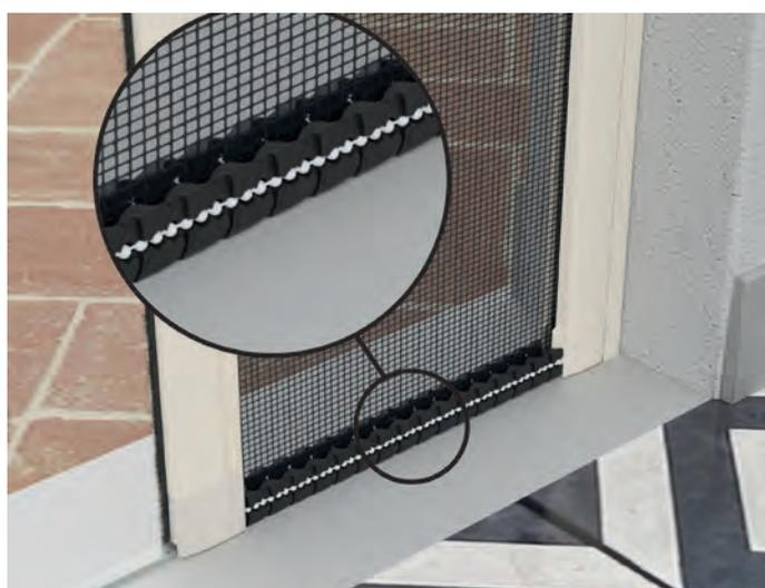
Il carro inferiore specifico presenta un cavo di rinforzo in kevlar, che collega i singoli componenti rendendoli solidali e resistenti. Questa caratteristica riduce sensibilmente il bradeggio laterale a tutto vantaggio della fluidità di scorrimento e della durata nel tempo del prodotto.
