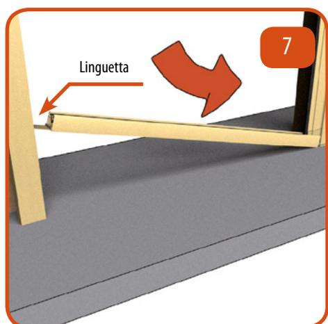
Inserire la linguetta spingi profilo all'estremità della guida inferiore e posizionarla a terra inserendola nell'aletta della testata.
