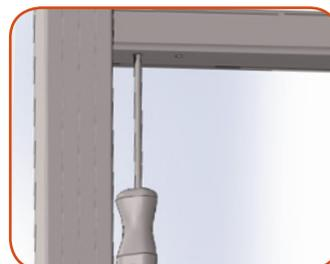
Per regolare la carica di ritorno nella zanzariera sarà sufficiente inserire il cacciavite con la testa esagonale nel foro situato sul lato inferiore della guida superiore (lato cassonetto) ed agire in senso orario o antiorario per caricare o scaricare la molla.
