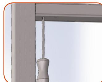
Per regolare la carica di ritorno nella zanzariera sarà sufficiente inserire il cacciavite con la testa esagonale nel foro situato sul lato inferiore della guida superiore (lato cassonetto di competenza) ed agire in senso orario o antiorario per caricare o scaricare la molla.
