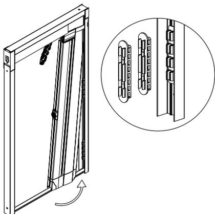
**8** Avvicinare la guida telescopica superiore verso il pacchetto rete, facendo inserire le alette presenti sulla cuffia telescopica all'interno delle scanalature del profilo.
