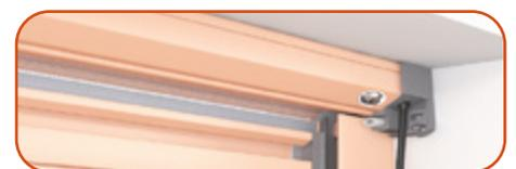
Regolare la carica della molla inserendo l'accessorio esagonale in un avvitatore elettrico ed agire nel foro posto nella testata riportante l'adesivo con la "chiocciola".
