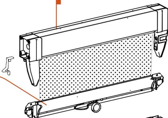
Clip per fissaggio al controltaio per versione incasso
