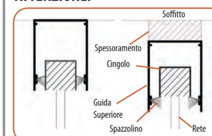
Nella figura sono riportate le viste in sezione del particolare della guida superiore con e senza spessoramento. Nel caso in cui la situazione sia come quella della figura di sinistra, siamo in presenza di una anomalia, in quanto gli spazzolini non sostengono i cingoli: di conseguenza, in questo caso è necessario spessorare come indicato nella figura di destra.
