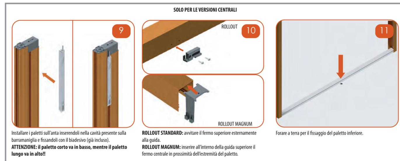
Installare i paletti sull'anta inserendoli nella cavità presente sulla barramaniglia e fissandoli con il biadesivo (già incluso).
