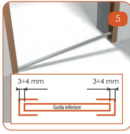
Controllare che la guida a terra sia circa 8 mm più corta dello spazio interno fra le 2 guide laterali. Togliere il biadesivo e posizionare la guida a terra in asse con quanto già montato e centrata fra le 2 guide laterali.
