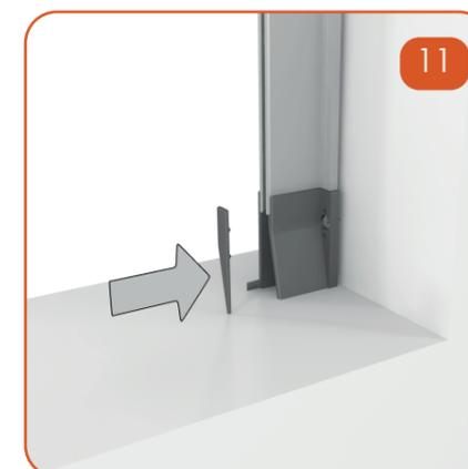
RV 92: Una volta terminata l'installazione applicare le mascherine o i tappini ai piedini, se necessario utilizzare un martello per l'inserimento.
