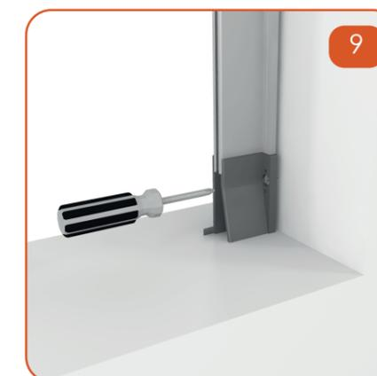
RV 92 Fissare con delle viti adeguate i piedini.
